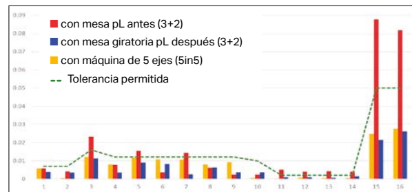
Error en los puntos de medición antes y después de APS precisión para procesamientos 3D.
