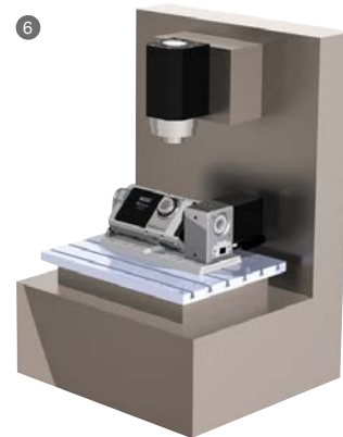
6 4. + 5. eje, 1 husillos, montaje X (transversal)
