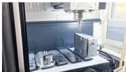
Aplicación de un 4º eje en un centro de procesamiento de 3 ejes
