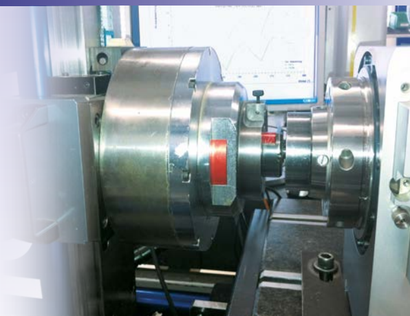
Instalación automática de medición de Precisión del indexado
