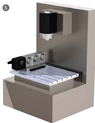
5 Eje, 3 husillos, Montaje Y (transversal)
