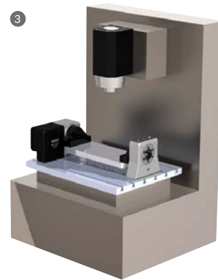
3 4. eje con puente giratorio, directamente en la mesa de la máquina
