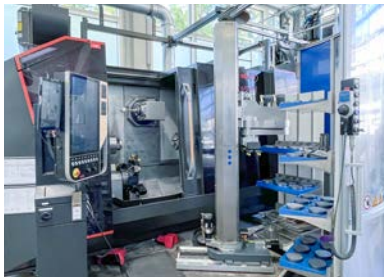
Con pool di pezzi per la produzione senza operatori
