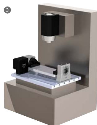
4° asse con ponte girevole, direttamente sulla tavola della macchina
