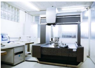
Mesure d'un boîtier sur mesureuse 3D
