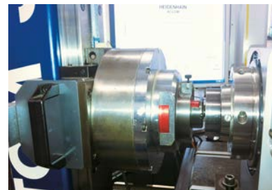
Mesure de la précision d'indexage – entièrement automatisée
