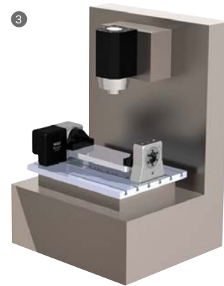
3 4ème axe avec pont pivotant, directement sur la table de machine
