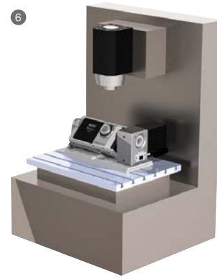
6 4ème + 5ème axe, 1 broches, montage en X (longitudinal)
