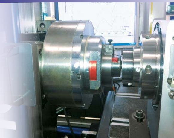
Vollautomatische Messanlage für Teilgenauigkeitsmessung
