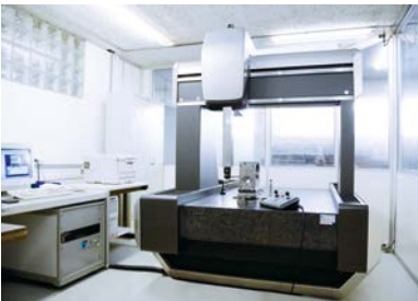
Vermessung eines Gehäuses auf einer 3D-Messmaschine
