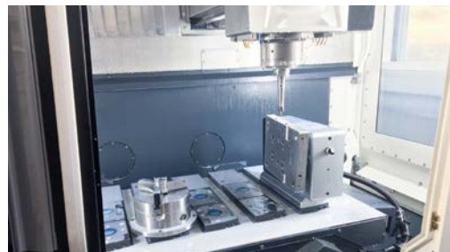
Applikation einer 4. Achse auf einem 3-Achs-Bearbeitungszentrum
