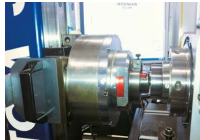
Vermessung der Teilgenauigkeit – vollautomatisch
