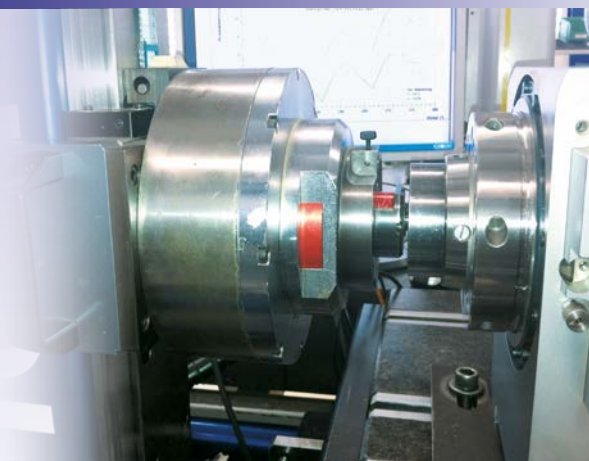
全自动测量设备，用于分度精度测量
