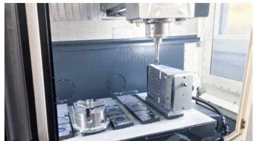
将一个第 4 轴应用到 3 轴加工中心上
