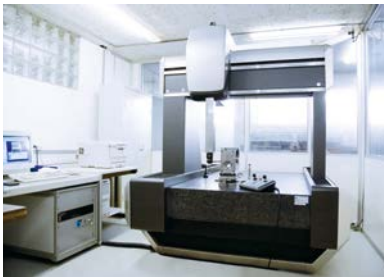
测量 3D 测量机上的壳体
