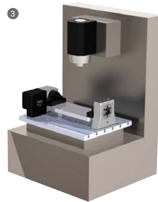
3 第4轴，带旋转桥，直接在机床工作台上
