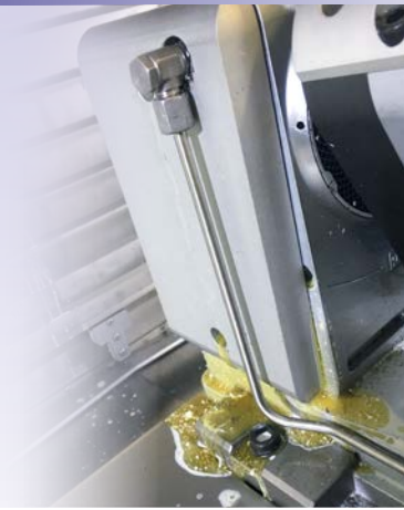
大量のオイル損失
