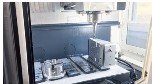
3軸マシニングセンターへの4軸の適用
