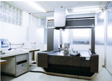
3D ölçüm makinesinde bir gövde ölçümü
