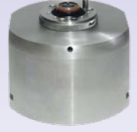
newChuck: Örneğin entegre ripas ile 5. veya 6. tarafın işlenmesi için ideal tabla aynası
