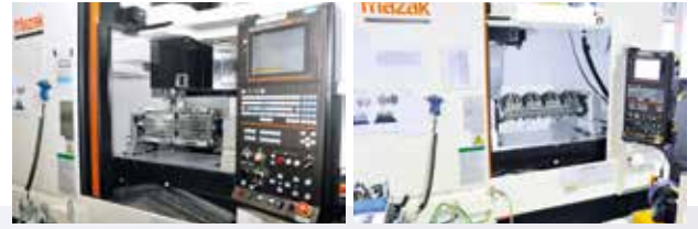
Erfolgskombination 3+1 Achsen: Die mit pL LEHMANN-Drehtischen ausgestatteten Mazak-Bearbeitungszentren sorgen bei SMC für eine deutliche Effizienzsteigerung und hohe Präzision. Bilder: pL LEHMANN
