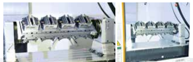
Mehrfachspannung: Die von SMC gebaute Brücke zwischen Drehtisch und Gegenlager erlaubt mit entsprechenden Aufnahmen die gleichzeitige Spannung von bis zu acht Werkstücken in Gegenlage.
