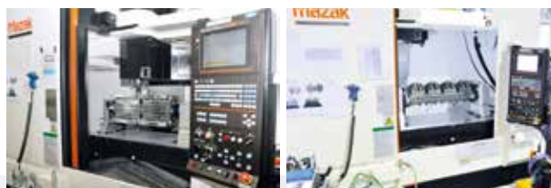
Combinaison réussie à 3 axes + 1 : les centres d'usinages Mazak équipés de plateaux rotatifs pL LEHMANN ont permis à SMC d'améliorer nettement leur efficacité et leur précision. Photos : pL LEHMANN
