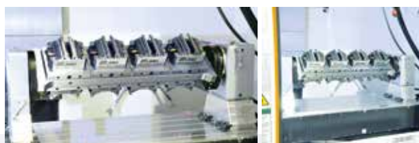
Serrage multiple : la bride conçue par SMC entre le plateau rotatif et le contre-palier permet, avec les supports adaptés, de serrer simultanément jusqu'à huit pièces placées en vis-à-vis.
