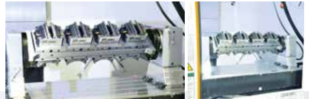
多重夹紧：由 SMC 在转台与止推轴承之间安装的桥件允许使用相应的夹紧件在止推位置上同时夹紧多达 8 个工件。
