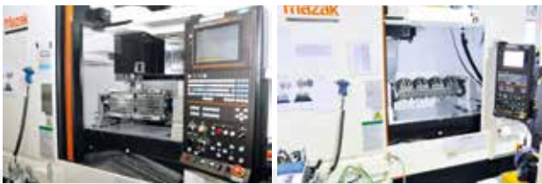
成功组合 3+1 轴：配备 pL LEHMANN 转台的 Mazak 加工中心确保在 SMC 明显提升效率与高精度。 图片：pL LEHMANN
