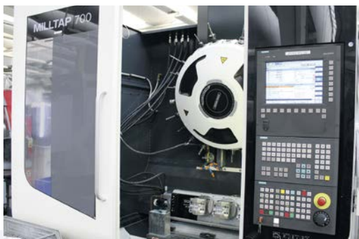
Una combinazione di successo, gli assi 3+2: le DMG MORI Milltap 700 dotate delle tavole rotanti pL LEHMANN garantiscono a WSS un'efficienza notevolmente maggiore e un'elevata precisione.
