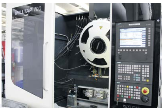
成功组合 3+2 轴：配备 pL LEHMANN 转台的 DMG MORI Milltap 700 确保在 WSS 明显提升效率与高精度。
