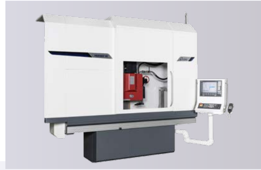
Die BLOHM PROFIMAT MT bietet hochwertige Schleiftechnologie für das Profilschleifen.
