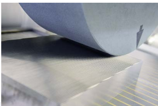
Rectification d'une mâchoire à filet avec biseaux en entrée et en sortie.
