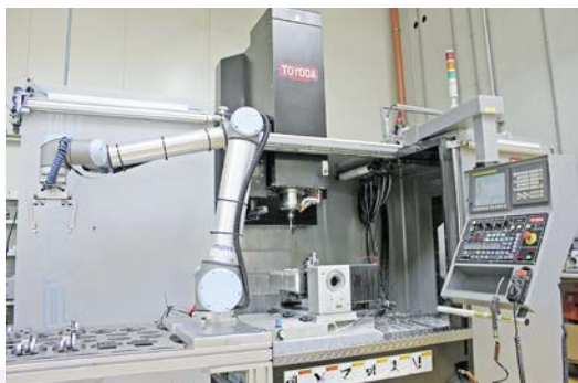
Das Toyoda BAZ FV1165 wurde von MBN mit einem ein URC Gelenkarm-Roboter automatisiert. Resultat: 20 Prozent höhere Produktivität.
