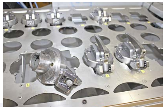
Die mit dem Bauteil bestückten ripas-Paletten werden über den HSK-A63 gespannt.
