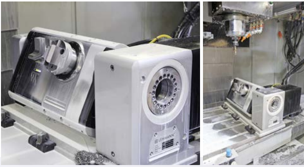
Auf dem Toyota BAZ FV1165 mit pL LEHMANN-Drehtisch T1-510520.LL fixX bearbeitet MBN nicht nur medizintechnische Teile fünfachsig. Die technischen Möglichkeiten dieser Kombination sind für eine Vielzahl an Werkstücken vorteilhaft.
