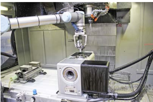
Der Roboter belädt hier den pL LEHMANN CNC-Drehtisch T1-510520.LL fixX mit Titan-Rohlingen für Hüftprothesen.
