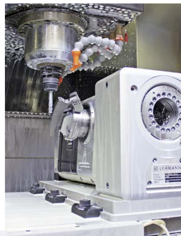
Der pL LEHMANN CNC-Drehtisch T1-510520.LL fixX macht aus der vertikalen, dreiachsigen Toyoda-Fräsmaschine ein fünfachsiges Bearbeitungszentrum, mit dem sich komplexe Bauteile komplettbearbeiten lassen.
