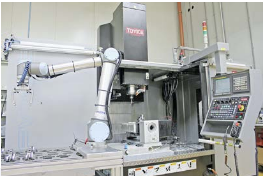
El centro de mecanización FV1165 de Toyoda ha sido automatizado por MBN mediante un robot de brazo articulado URC. Resultado: incremento del 20 por ciento de la productividad.
