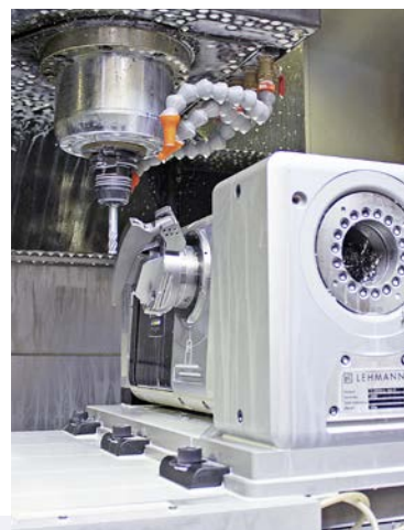
Поворотный стол с ЧПУ LEHMANN T1-510520.LL fixX превращает вертикальный трехосевой фрезерный станок Toyota в пятиосевой обрабатывающий центр, на котором можно выполнять комплексную обработку сложных деталей.
