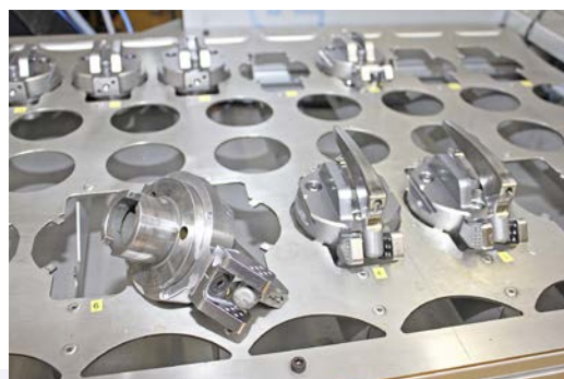
Палеты giras с установленными заготовками зажимаются с помощью HSK-A63.
