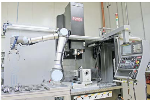
Обрабатывающий центр Toyota FV1165 автоматизирован фирмой MBN путем установки робота с шарнирным манипулятором URC. Результат: производительность повысилась на 20 процентов.
