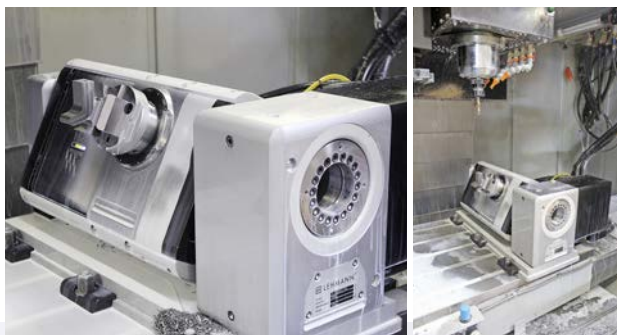
На обрабатывающем центре Toyota FV1165 с поворотным столом LEHMANN T1-510520.LL fixX в компании MBN обрабатывают по пяти осям не только детали для медицинской техники. Технические возможности этой комбинации полезны при обработке очень большого спектра заготовок.
