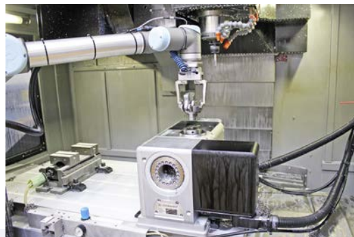
Робот устанавливает на поворотный стол с ЧПУ LEHMANN T1-510520.LL fixX титановые заготовки для протезов тазобедренных суставов.
