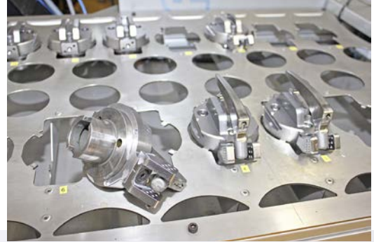
Aksamla donatılan ripas paletleri HSK-A63 üzerinde gerilim yapıyor.
