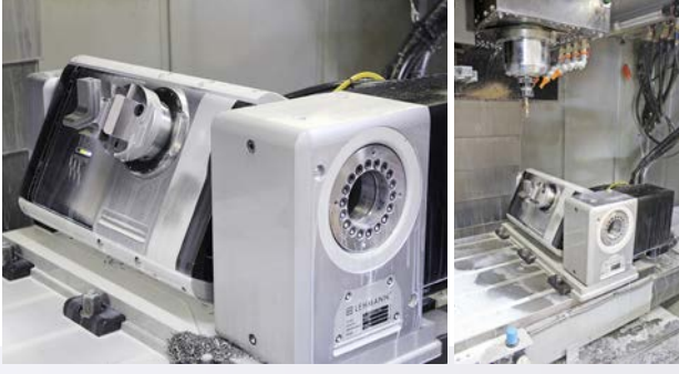
MBN pL LEHMANN döner tablalı T1-510520.LL fixX Toyota BAZ FV1165'de sadece tıbbi teknik parçaları beş eksenli üretmiyor. Bu kombinasyonun teknik imkânları pek çok aksam için avantajlı.
