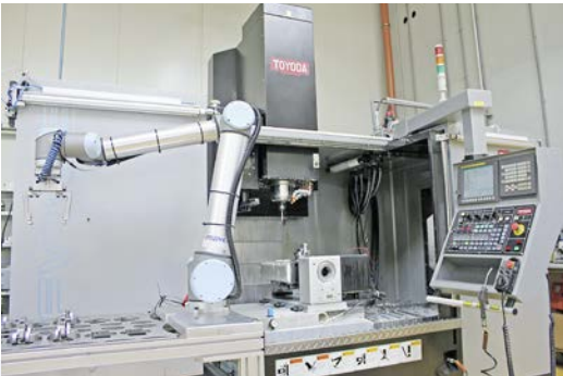
Toyoda İşleme Merkezi FV1165, MBN tarafından URC eklemli bir kol robotuyla otomatize edildi. Sonuç: yüzde 20 daha yüksek üretim.
