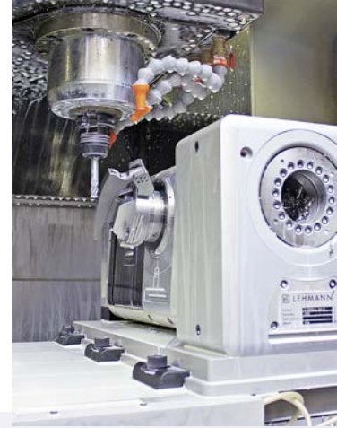
pL LEHMANN CNC döner tabla T1-510520.LL fixX vertikal, üç eksenli Toyoda freze tezgahında karmaşık aksamları komple işleyebilen beş eksenli bir işleme merkezi oluşturuyor.
