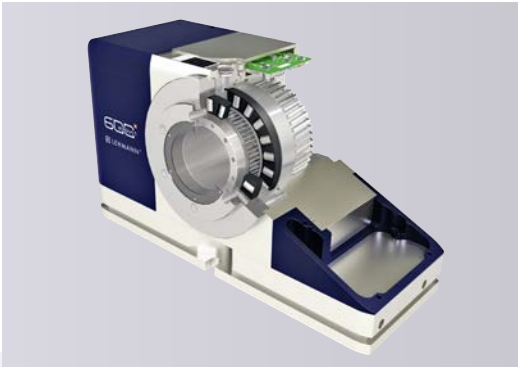
Yeni 600 serisi CNC döner tablalar (EA-640 resminde) simetrik yapıdadır. Bunlar, yüksek performanslı eşzamanlı işlemeyi de mümkün kılan boşluksuz, sürekli ön gerilmeli PGD dişli kutusu ile donatılmıştır.
