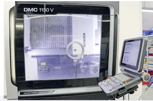
Das Vertikal-Bearbeitungszentrum DMG MORI DMC 1150V bietet genügend Platz, um neben dem Lehmann-Drehtisch noch eine weitere Spannvorrichtung einzusetzen.
