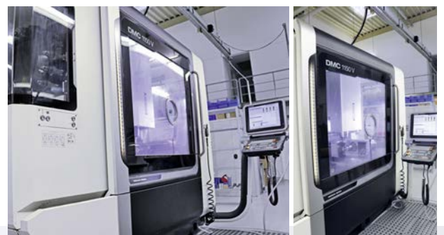
2015 ergänzte Jongen seinen Maschinenpark um zwei DMG MORI DMC 1150V, die mit dem ergänzten Schwenkdrehtisch T1-520520.RR varioX von pL LEHMANN fünfachsig bearbeiten können.
