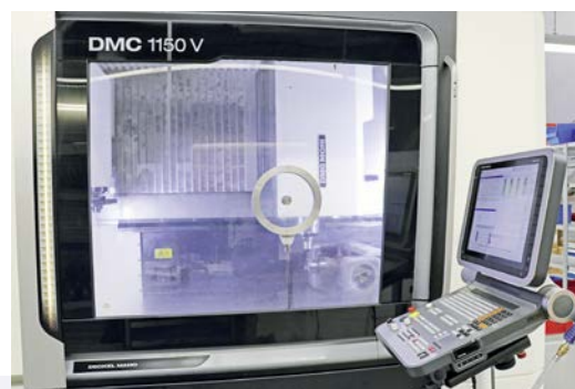
Le centre de traitement vertical DMG MORI DMC 1150V offre suffisamment de place pour pouvoir utiliser un autre dispositif de serrage en plus de la table rotative Lehmann.
