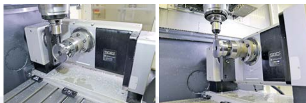
Les tables rotatives Lehmann de la série 500 présentent des couples de blocage deux fois plus importants ainsi que des vitesses et des reproductibilités beaucoup plus élevées que les versions 400.
