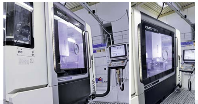
En 2015, Jongen a complété son parc machines de deux DMG MORI DMC 1150V capables de fonctionner à cinq axes avec la table rotative pivotante complétée T1-520520.RR varioX de pL LEHMANN.
