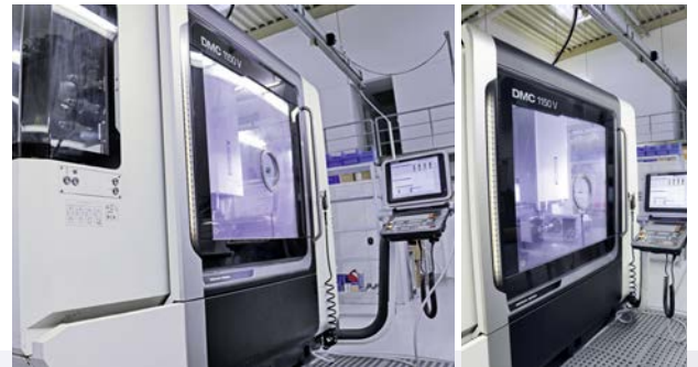
2015 年，Jongen 为其机床仓库添加了两台 DMG MORI DMC 1150V，加入了 pL LEHMANN 的摇摆转台 T1-520520.RR varioX，能够实现五轴加工。
