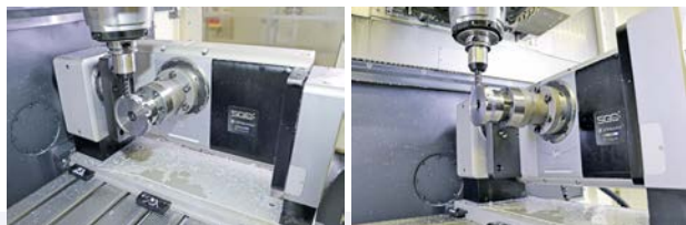
与之前的 400 系列相比，Lehmann 500 系列转台的夹紧力矩翻倍，展现出了更高的速度和重复精度。
