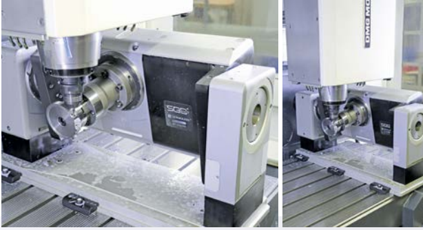
自 2015 年起，Jongen 就采用 Lehmann 转台 T1-520520.RR varioX，该转台因精确快速及大夹持力而令人信赖。
