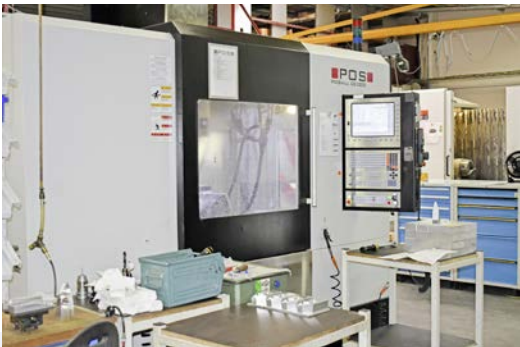
Combinación de éxito 3+2 ejes: La máquina POSmill CE 1000, equipada con una mesa giratoria de pL LEHMANN, ofrece importantes ventajas para la gama de piezas en Wackershauser und Fauth.
