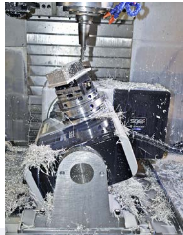
Fácil de reconocer: a través de la tensión en una mesa giratoria colocada, pueden usarse herramientas cortas, de pocas vibraciones.
