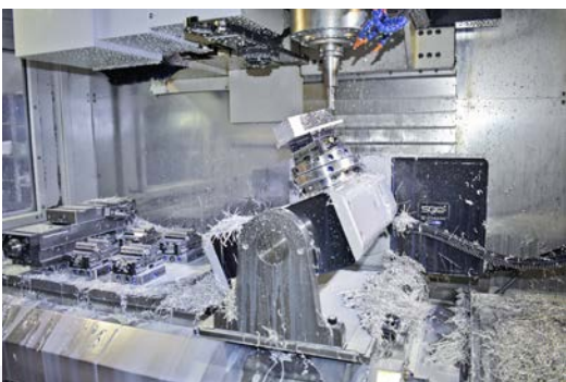
La máquina puede ser equipada con hasta diez tornillos, sin desinstalar la mesa giratoria pL LEHMANN.
