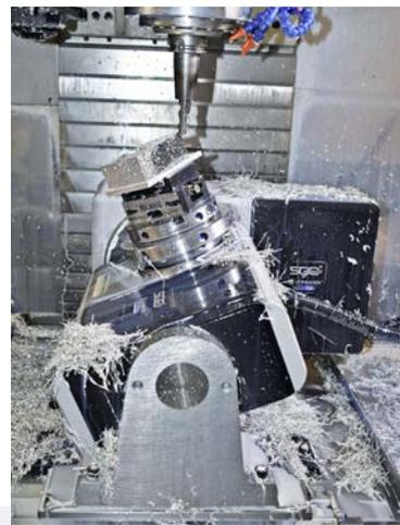
Хороший обзор: благодаря зажиму в установленном поворотном столе могут использоваться короткие инструменты с низким уровнем вибрации.
