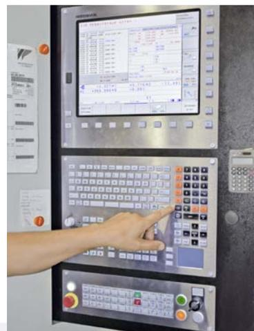
Серийный обрабатывающий центр POSmill CE 1000 оснащен системой ЧПУ Heidenhain iTNC 530.
