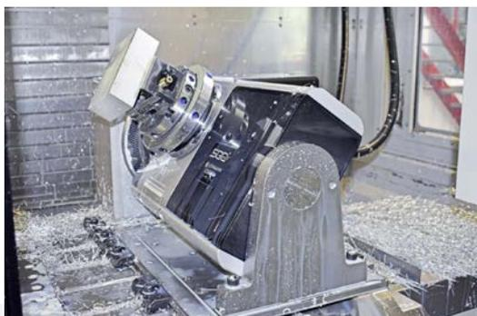
На поворотном столе pL LEHMANN легко обрабатывать типовые детали диаметром до 280 мм и весом до 90 кг.
