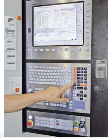
POSmill CE 1000 standart olarak bir Heidenhain iTNC 530 ile donatılmıştır.
