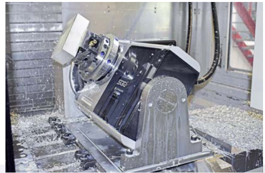
280 mm çapa ve 90 kg'a kadar ağırlığa sahip parçalar pL LEHMANN tablalarında standart sürüm içerisinde problemsiz bulundurulabilir.
