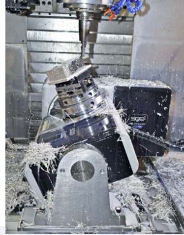
Bilmekte fayda var: Monte edilmiş bir döner tabladaki hat üzerinden kısa az sallanan aletler yerleştirilebilir.
