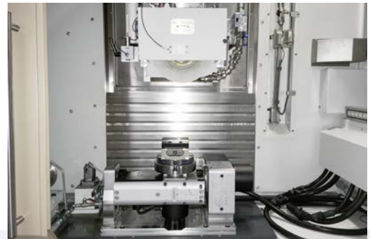
Eingesetzte Schleifscheibe mit 300 mm Durchmesser, inklusive den zwei Abrichtstellen. Die hintere Stelle für planes Abrichten und hinterziehen der Schleifscheibe, vorne eine Formrolle zur Profilabrirchtung.
