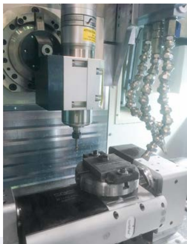
La fraise serrée sert à l'usinage des surfaces des couches appliquées à l'aide du procédé LMD.
