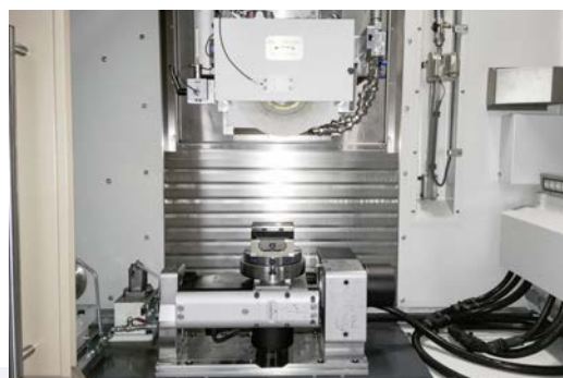
Diamètre de la meule utilisée 300 mm avec les deux emplacements de rabotage. Emplacement du fond pour le rabotage plan et le déplacement de la meule vers l'arrière, emplacement à l'avant équipé d'un rouleau de formage pour le rabotage de profil.
