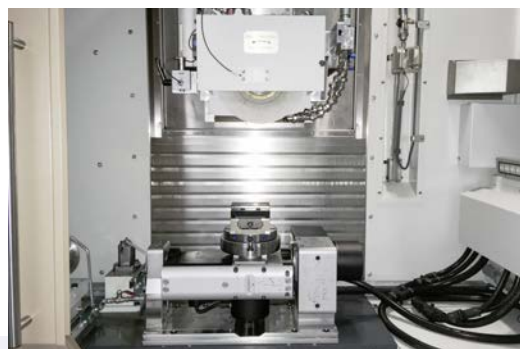
Mola di rettifica utilizzata, di 300 mm di diametro, inclusi i due punti di levigatura. La parte posteriore è per la levigatura piana e la spinta all'indietro della mola di rettifica, mentre la parte anteriore è un rullo di formatura per la profilatura.
