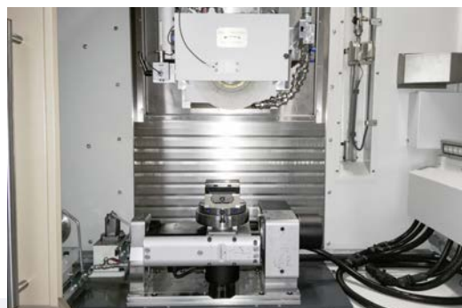
Установленный шлифовальный круг диаметром 300 мм, включая две точки правки. Задняя точка для торцевой правки и отклонения шлифовального круга, спереди — профильный ролик для профильной правки.
