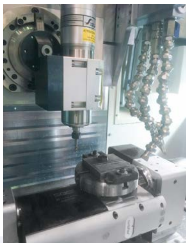
Закрепленная фреза служит для чистовой обработки поверхностей слоев, нанесенных методом лазерной наплавки.
