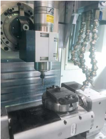
Sıkıştırılmış freze bıçağı, LMD vasıtasıyla uygulanan tabakaların yüzey işlemlerine hizmet eder.
