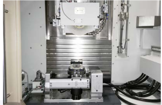
İki adet düzenleme noktası dahil 300 mm çapında takılmış taşlama tekerleği. Arka bölüm düzleme ve taşlama diskinin arkadan çekilmesi amacıyla önde profil çıkarma için bir biçimlendirme silindiri.
