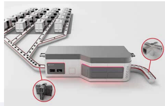
links: Das Verfahren kann für kommende Großserien auch in Finishingstraßen einer H12000 mit einer Kapazität von 500 Teilen pro Stunde umgesetzt werden. rechts: Der Vakuumbreifer aus Edelstahl ist nach dem Finishing mittels Hirtisieren® von den Supports befreit und einsatzfertig. (Bilder: Materialise)
