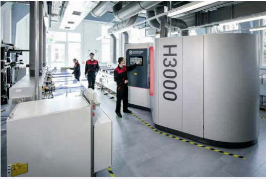
Le module de finition H3000 est une machine autonome « Plug-and-play » servant au post-traitement des pièces imprimées 3D avec le procédé breveté d'hirtisation®.
