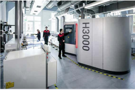
El módulo de acabado H3000 es una máquina «Plug-and-play» independiente para el postprocesamiento automático de piezas de impresión 3D con el proceso patentado Hirtisieren®.
