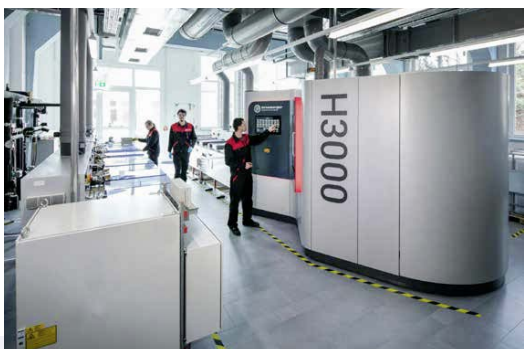
Модуль завершающей обработки H3000 представляет собой самостоятельную установку Plug-and-play для автоматической постобработки деталей 3D-печати запатентованным методом Hirtisation®.
