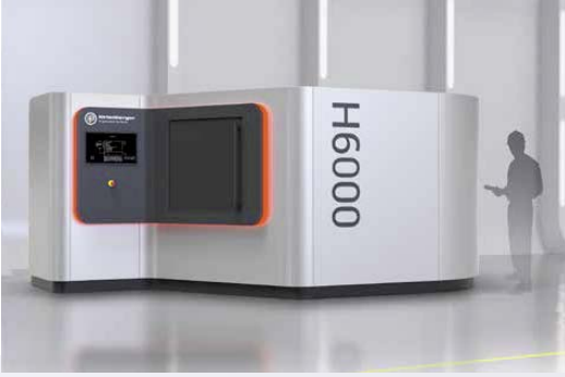
500 x 500 x 300 mm'lik boyutlarıyla H6000, H3000'e oranla çok daha büyük bir çalışma alanına sahip. Farklı malzemelerde birden çok parçayı eşzamanlı olarak art işleme tabi tutabiliyor.
