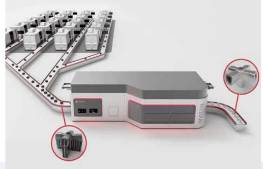
solda: Gelecekteki yüksek hacimli seriler için yöntem, saat başına 500 parça kapasiteli bir şekilde H12000 sistemi yüzey işleme yollarına da entegre edilebiliyor. sağda: Paslanmaz çelik vakumlu tutucu, hirtizasyon® ile son yüzey işleme sonrasında desteklerden çıkarılmış ve yeniden kullanıma hazır durumda. (Resimler: Materialise)
