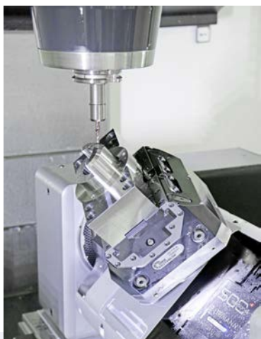
La table rotative CNC T1-510520.RR TOP2 de pL LEHMANN transforme la fraise Mazak VCN 530C à trois axes en un centre d'usinage à cinq axes, permettant d'usiner intégralement des composants complexes.
