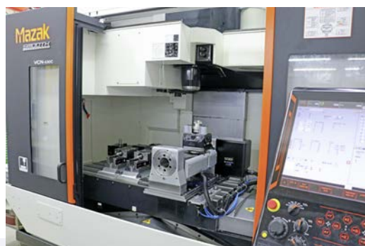
Mazak permet de programmer très rapidement et de manière ergonomique le centre d'usinage VCN 530C avec la table rotative CNC de pL LEHMANN en complément via la commande Mazatrol SmoothG. Une programmation G-Code n'est nécessaire que pour les opérations d'usinage spéciales.
