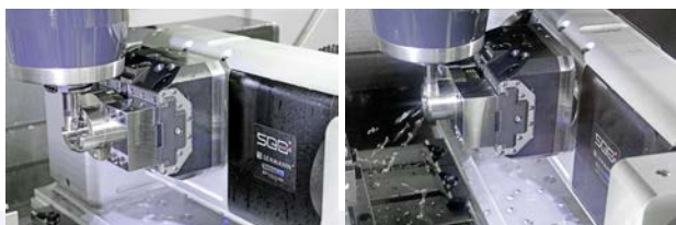
Le contre-palier fixé et les forces de maintien élevées permettent de serrer les pièces en acier inoxydable. Une durée d'usinage de 25 minutes était auparavant nécessaire à LOESCH T-P-L pour apposer des dispositifs de serrage spéciaux sur la pièce représentée sur l'image et apposer des perçages et des surfaces inclinés. Un serrage est désormais terminé en dix minutes.
