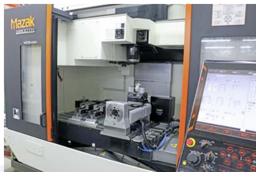
Mazak позволяет легко и быстро программировать трехосевой обрабатывающий центр VCN 530C с дополнительным столом с ЧПУ производства pL LEHMANN с помощью системы управления Mazatrol SmoothG. Программирование с помощью G-кода необходимо только для специальных операций обработки.
