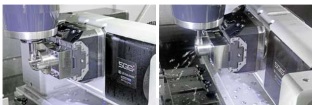
Фиксированная контропора и высокие усилия зажима позволяют обрабатывать резкой даже детали из высокосортной стали. Ранее компании LOESCH T-P-L требовалось 25 минут на обработку детали, показанной на иллюстрации, а также специальные зажимные приспособления для создания наклонных отверстий и плоскостей. Теперь заготовку нужно зафиксировать всего один раз, а обработка завершится через десять минут.
