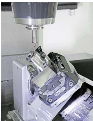
Поворотный стол с ЧПУ T1-510520.RR TOP2 компании pL LEHMANN превращает вертикальный трехосевой фрезерный станок Mazak VCN 530C в пятиосевой обрабатывающий центр, на котором можно выполнять комплексную обработку сложных деталей.
