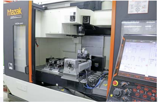
Mazak, üç eksenli VCN 530C işleme merkezini, pL LEHMANN'ın ilave CNC döner tezgahı ile Mazatrol SmoothG kumandası üzerinden çok hızlı ve kullanıcı dostu bir şekilde programlamayı mümkün kılar. G kodu programlama sadece özel işleme işlemleri için gereklidir.
