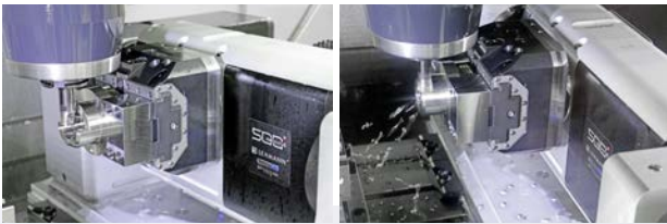
Sıkıştırılmış karşı yatak ve yüksek tutma kuvvetleri sayesinde, paslanmaz çelik parçalar da yontulabiliyor. LOESCH T-P-L, resimde gösterilen yapı parçası için 25 dakikalık bir işleme süresine ihtiyaç duyuyordu ve ayrıca eğik delikleri ve yüzeyleri tutturmak için özel sıkıştırma cihazları gerekiyordu. Şimdi bir sıkıştırma içerisinde on dakika sonra işlenmiş oluyor.
