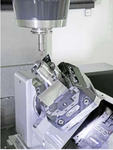
LEHMANN'dan CNC döner tezgah T1-510520.RR TOP2 dikey, üç eksenli Mazak VCN 530C freze tezgahında karmaşık aksamı komple işleyebilen beş eksenli bir işleme merkezi oluşturuyor.
