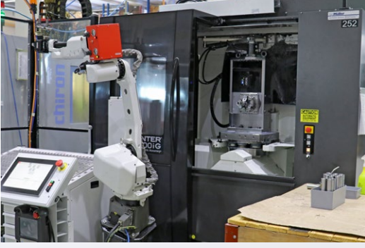
Değiştirme tablası ve bir robotlu otomasyon sayesinde Kitamura/pL LEHMANN sistemi son derece ekonomik 7 gün 24 saat çalışmayı mümkün kılıyor.
