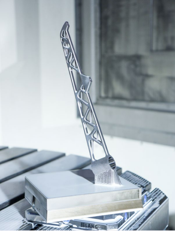
İşleme merkezi üzerinde ek işlem: Eklemeli imalat ile üretilen parçalar, tekli AM-LOCK segment paletleri üzerindeki sıfır nokta bağlama sisteminde bağlanıyor.
