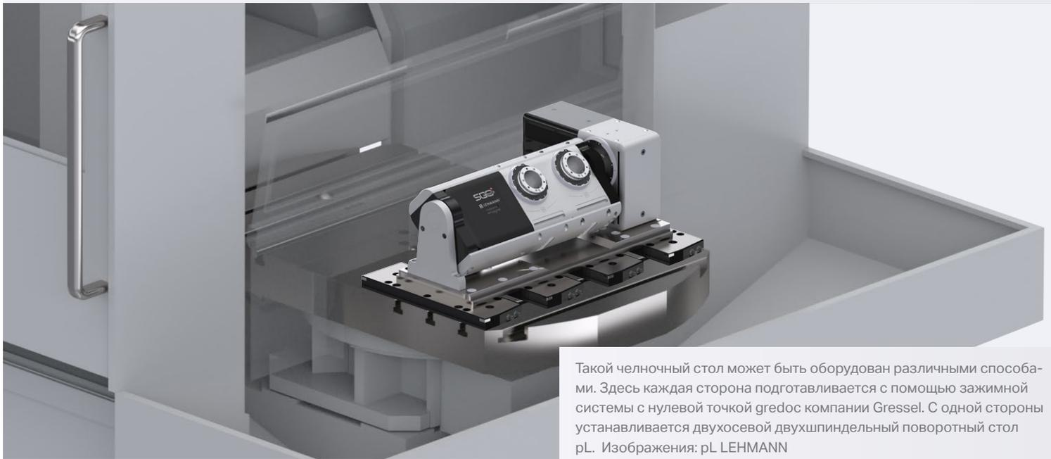
Такой челночный стол может быть оборудован различными способами. Здесь каждая сторона подготавливается с помощью зажимной системы с нулевой точкой gredoc компании Gressel. С одной стороны устанавливается двухосевой двухшпиндельный поворотный стол pL. Изображения: pL LEHMANN
