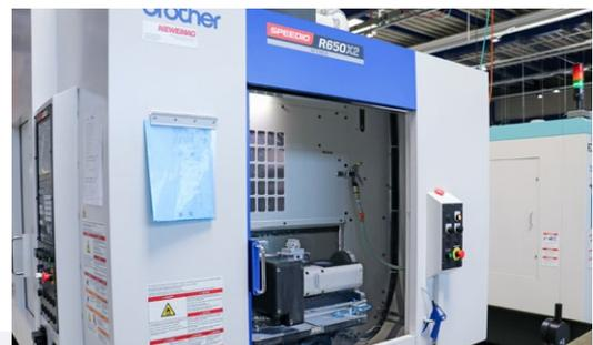
Как это выглядит на практике: в этом фрезерно-сверлильном центре Brother Speedio R650X2, оснащенном челночным столом, обе половины стола оборудованы двухосевым поворотным столом с ЧПУ производства компании pL LEHMANN.
