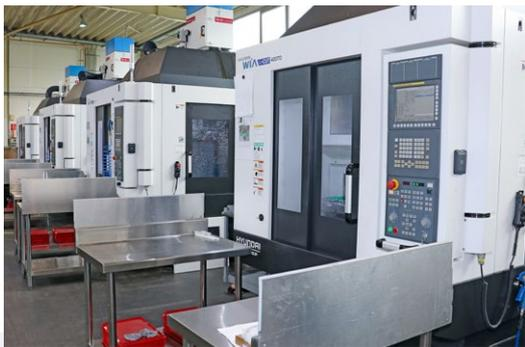
Mull investierte für den Auftrag insgesamt in vier Bohr-Fräszentren Hyundai WIA i-CUT 400TD. Eines davon ist für anspruchsvolle Bearbeitungen mit dem pL-Drehtisch EA-507 ausgestattet.
