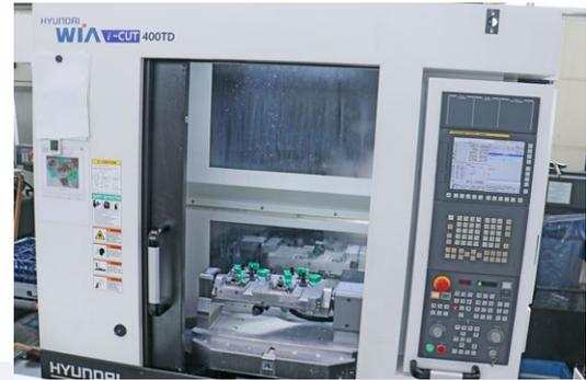
Das kompakte Bohr-Fräszentrum Hyundai WIA i-CUT 400TD ist für E-Bike-Getriebe- und Gehäuseteile optimal geeignet. Der ergänzende pL-Drehtisch EA-507 wird als vierte Achse direkt über die CNC angesteuert.
