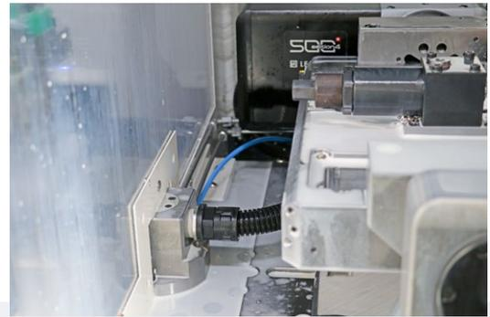
Es wurde ein Drehdurchführungskonzept erarbeitet, um die beiden Arbeitstische und die darauf befindlichen Zusatzachsen mit Daten-, Strom- und Hydraulikleitungen zu versorgen.
