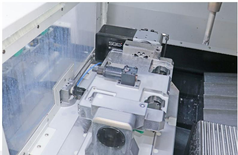
Blick in den Arbeitsraum, wo vier Bauteile fertigbearbeitet werden können, während auf der anderen Wechseltisch-Hälfte gerüstet wird.
