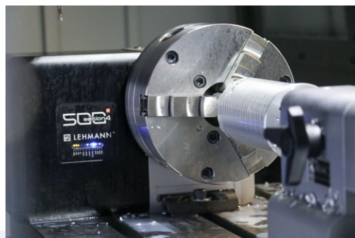
Durch die große Variantenvielfalt der pL LEHMANN-Drehtische musste SPINOGY keine Kompromisse eingehen. Die Baugröße EA-510 passt perfekt zur Bauteil- und Maschinengröße.
