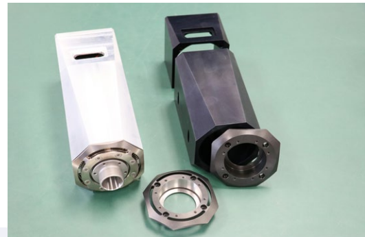
Die Gehäuseteile erfordern aufgrund ihres Designs eine vierachsige Bearbeitung (rechts das anschließend eloxierte Gehäuse).
