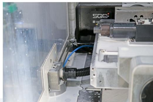
È stato elaborato un concetto di passante tornito per alimentare le due tavole da lavoro e gli assi aggiuntivi su di essi con linee di dati, di potenza e idrauliche.
