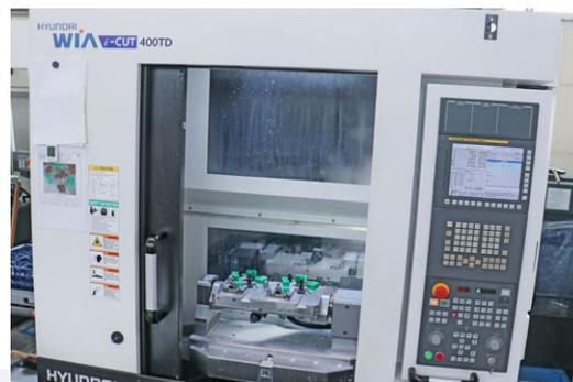
Il centro di foratura-fresatura compatto Hyundai WIA i-CUT 400TD è ideale per le parti del cambio e del carter delle e-bike. La tavola rotante supplementare pL EA-507 è controllata direttamente tramite il CNC come quarto asse.
