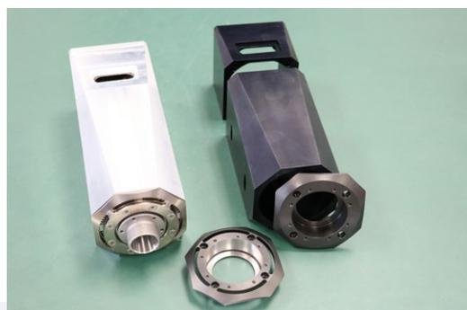
A causa del loro design, le parti dell'alloggiamento richiedono una lavorazione a quattro assi (a destra: l'alloggiamento successivamente anodizzato).
