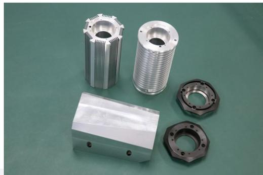
La particolarità dei mandrini motorizzati SPINOGY è il sistema modulare. Con pochissimi componenti diversi (nella foto, parti dell'alloggiamento e dissipatore di calore), si possono produrre molte varianti.
