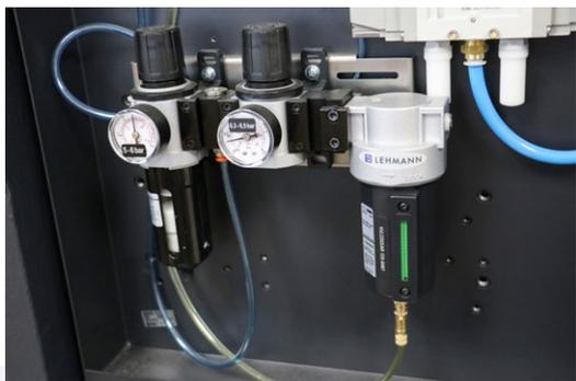
Nella parte posteriore della macchina Doosan DNM 4500, oltre all'intera unità di manutenzione, sono facilmente accessibili anche il riduttore di pressione e l'oliatore ad aria dei componenti pL LEHMANN.
