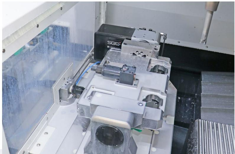
Vista de la sala de producción donde se pueden procesar hasta cuatro piezas, mientras se equipa la máquina en la otra mitad de la mesa de cambio. (Fotos: pL LEHMANN)
