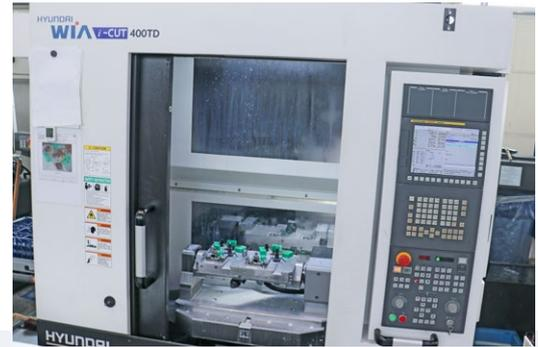
现代威亚 i-CUT 400TD 紧凑型钻攻铣销中心非常适用于电动自行车传动件和壳体件。附加 pL 旋转台 EA-507 作为第四轴直接通过 CNC 控制。
