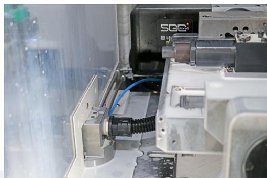
已制定一种旋转馈通方案，为两个工作台及其上的附加轴提供数据线、电线和液压管路。
