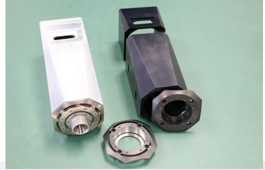
Tasarımları nedeniyle mahfaza parçaları dört eksenli işleme gerektirir (sağdaki eloksallı mahfaza).
