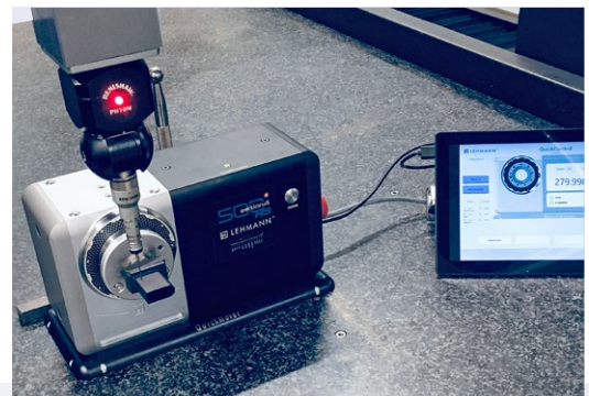
Q-Line 实际应用：在坐标测量机上测量一个电极
