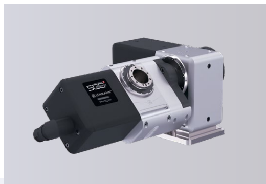
M-Line 的两轴转台 TF-507510 适用于重量达 40 公斤的工件。通过超紧凑的角度测量系统，定位精度可达到 \pm 2.5'' 。
