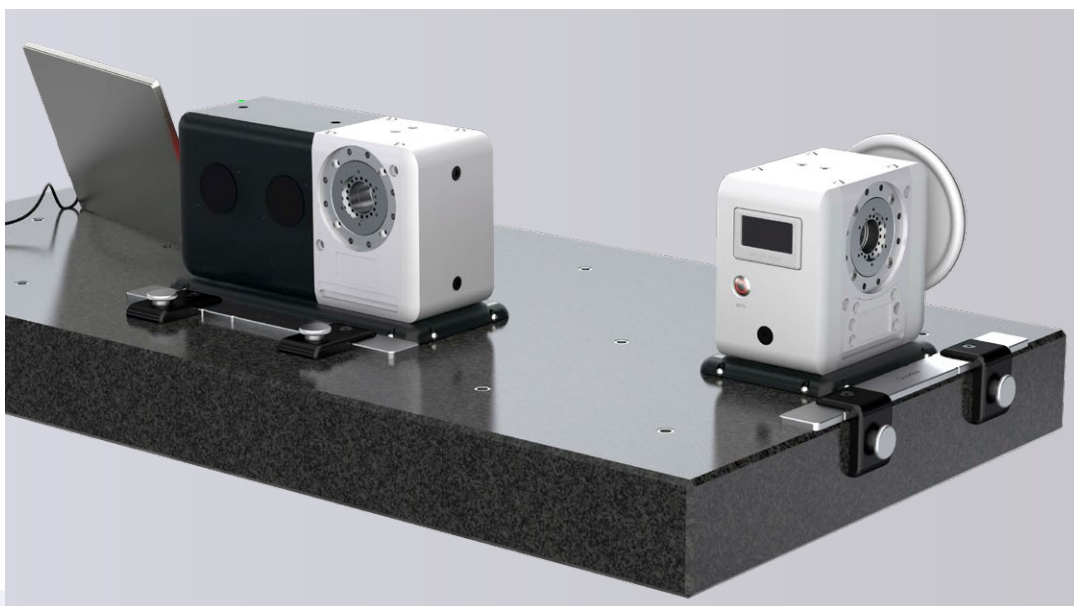
有了 QuickBar 零点系统，所有配备 QuickMover（气垫）的转台都能快速而精确地进入测量位置。QuickBar 有边缘和表面两种安装方式。借助自粘垫，不需要钻孔。QuickBar 也适用于 200 或 300 mm 的孔网。
