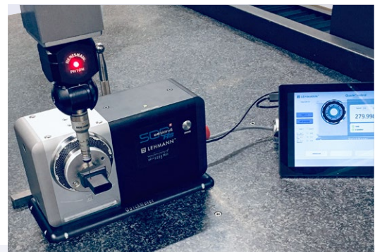
Q-Line im Einsatz: Vermessen einer Elektrode auf einem Koordinatenmess- gerät
