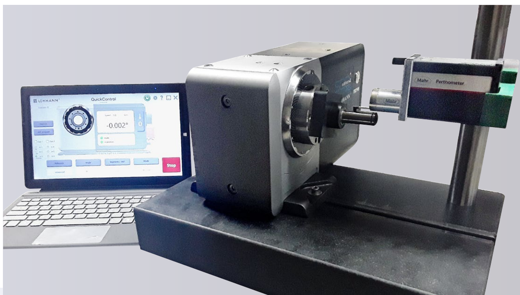
Auch zur Kontur- und Oberflächenmessung einer Welle lässt sich die Q-Line von pL LEHMANN einsetzen.
